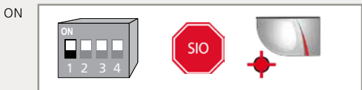
RELAIS 1: STOPP-Impuls auf Bandseite der Tür
