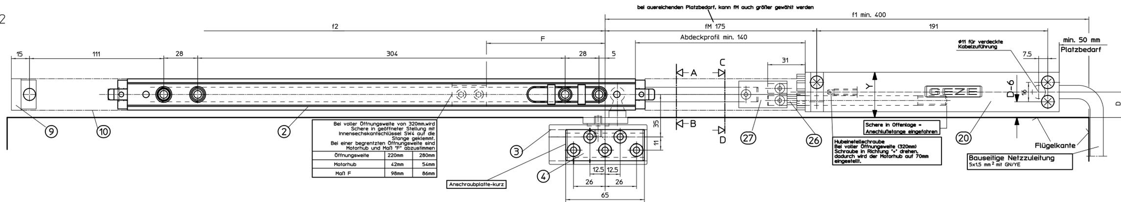
Bei voller Öffnungsweite von 320mm wird Schere in geöffneten Stellung mit Innensechskantenschlüssel SW4 auf die Stange geklemmt. Bei einer begrenzten Öffnungsweite sind Motorhub und Maß F abzustimmen
