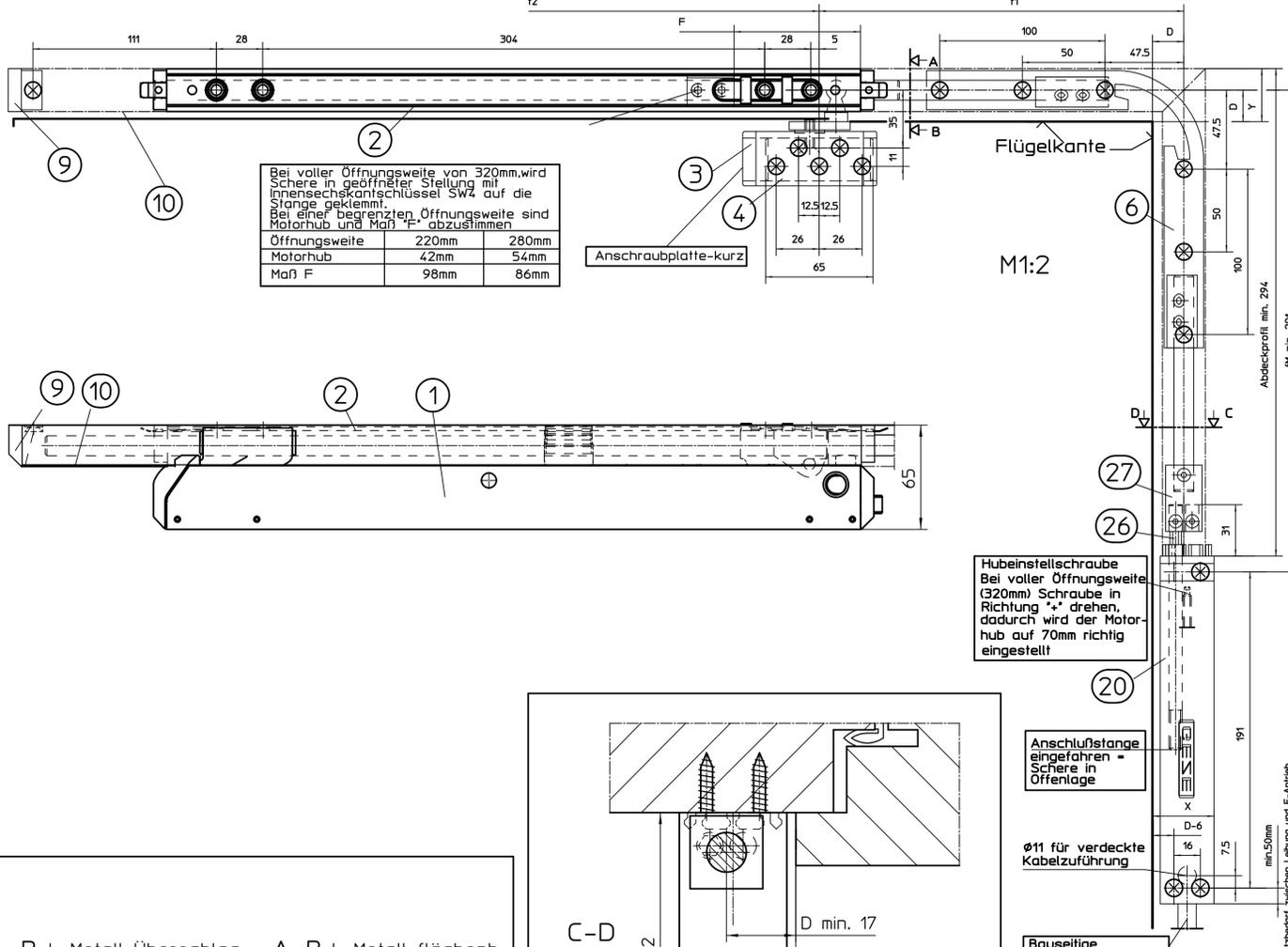
Bei voller Öffnungsweite von 320mm wird Schere in gedrehter Stellung mit Innensechskantschlüssel SW4 auf die Länge geklemmt. Bei einer begrenzten Öffnungsweite sind Motorhub und Maß F abzustimmen.
